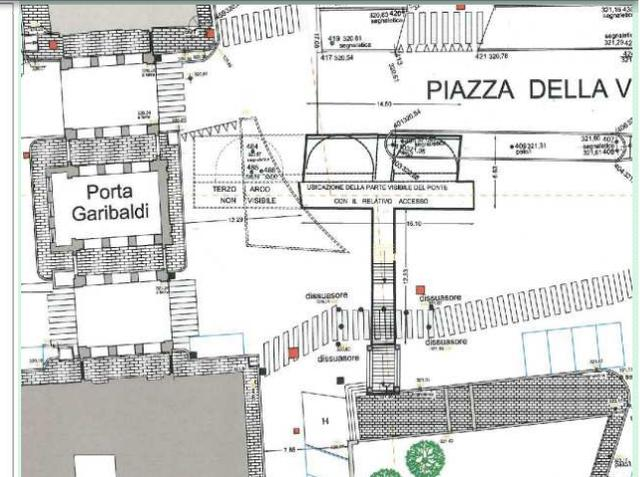
*Estratto del rilievo per la ricostruzione dello stato attuale con l'impronta del Ponte Sanguinario*
